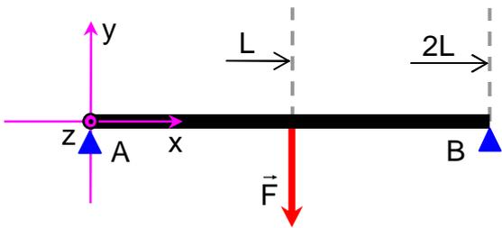
Conformément au croquis ci-contre une éprouvette de longueur  $2L$  et de section rectangulaire est soumise à un test de flexion 3 points.
