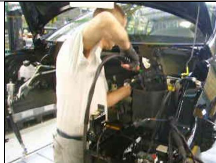
Photo 8 : Vissage écrou Avant maître-cylindre
