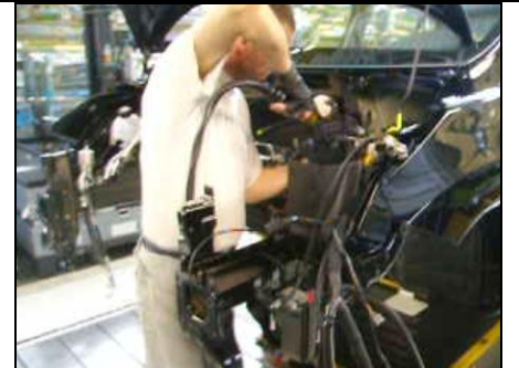
Photo 6 : Vissage écrou Arrière sur le maître-cylindre
