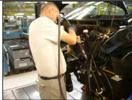
Photos 4 et 5 : Vissage 1 + 1 écrou sur le bloc ABR
