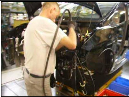
Photos 4 et 5 : Vissage 1 + 1 écrou sur le bloc ABR
