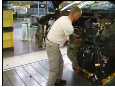
Photo 2 : Mise en place du tuyau de frein, retrait de 2 bouchons
