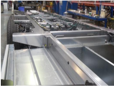
Fig. 1 : Châssis de type échelle en aluminium d'un poids lourd et son chargement
