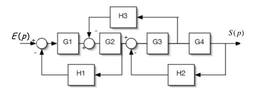
Simplifiez ces systèmes en détaillant les étapes, puis déterminez les fonctions de transfert en boucle fermée.
