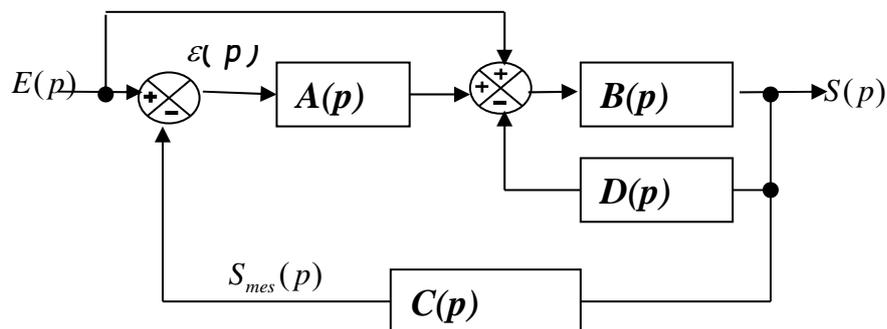
Simplifiez ce système en détaillant les étapes, puis déterminez la fonction de transfert en boucle fermée.
