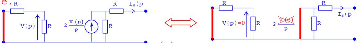
Si  $V_e(p)=0$ , alors  $V(p)=0$  et  $2 \frac{V(p)}{p} = 0$ . La sortie est alors équivalente à une simple résistance  $R$ .  $Z_s(p) = R$
