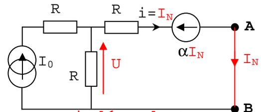
c. Pour obtenir  $R_{Th}$ , on éteint les sources indépendantes et on « mesure » la résistance entre les bornes A et B.
