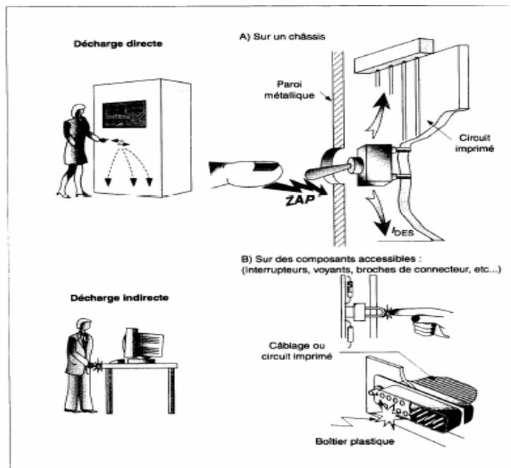
2.4 Application : tension induite dans une boucle de circuit imprimé ( $S = 2 \text{ cm}^2$ ) par une décharge d'électricité statique ( $t_m = 1 \text{ ns}$ ) de 20 A à 30 cm ? ( $B = \mu H$  ;  $\mu_0 = 4\pi \cdot 10^{-7} \text{ H/m}$ ).
