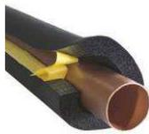
Nous vous conseillons d'isoler les tuyauteries avec un isolant flexible type **AF/ARMAFLEX ou équivalent** d'épaisseur environ **14 mm**. Cet isolant est constitué de mousse élastomère dont la conductivité thermique est 0,034 m°C/W.
