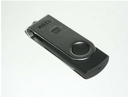
Dimensions approximatives (mm) de la clé : 60 x 18 x 10 ; de l'emballage : 134 x 134 x 34.
