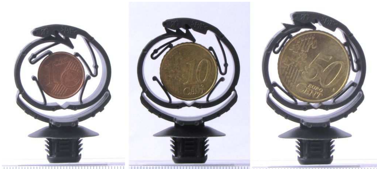
Figure 5 : Capacité du support faisceau. Une pièce de 1 Centime a un diamètre de 15 mm. Une pièce de 50 Cts a un diamètre de 24 mm
