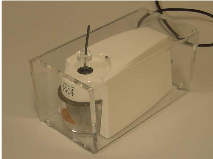
L'ordre de translation de l'effecteur permettant de séparer l'aiguille du corps de la seringue doit être émis lorsque le faisceau du capteur est coupé donc lorsque le corps de la seringue est mis en butée.
