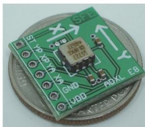
FIGURE 1 – Capteur de la série ADXL
