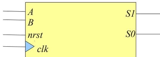
Il s'agit de réaliser un composant permettant de générer les commandes S1 et S0. Le séquenceur sera réalisé à l'aide d'une machine à états de Moore.
