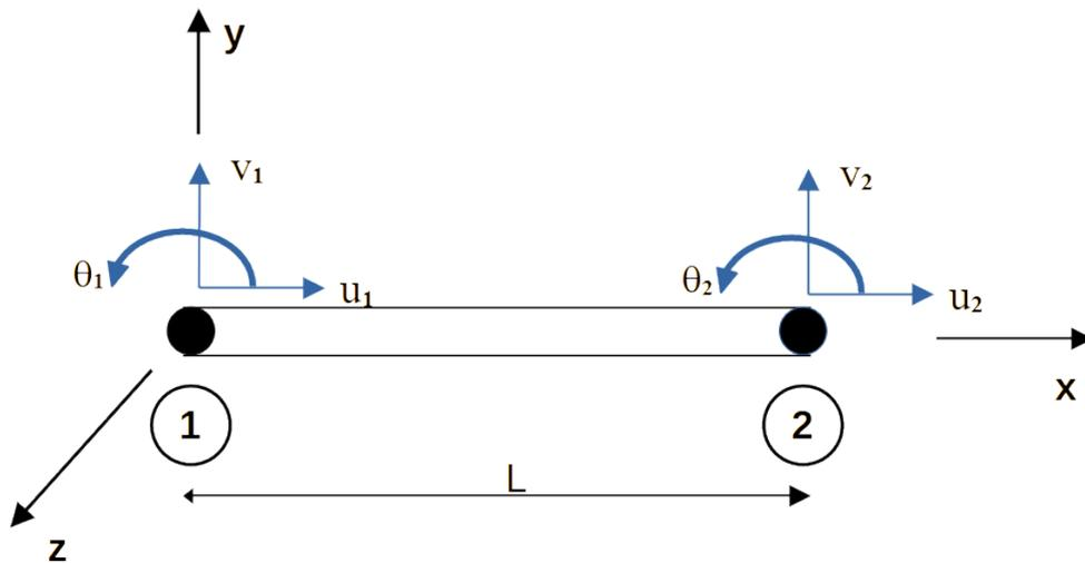
FIGURE 1 – Élément fini de poutre 2-D (portique plan)
