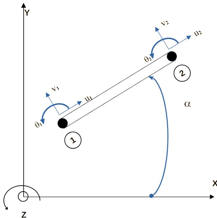
FIGURE 2 – Poutre 2-D dans le repère global  $(\vec{X}, \vec{Y}, \vec{Z})$
