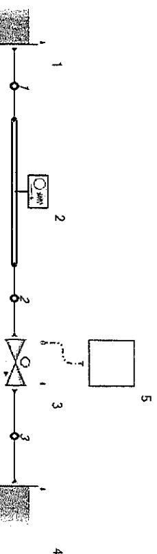
On considère le circuit ci-dessus dans lequel une canalisation (2) de longueur  $L$  et de diamètre  $d$  relie les réservoirs à niveaux constants (1) et (4). On place en bout de conduite, à l'entrée de (4) une vanne à biseau sphérique (3). On s'intéresse au cas où la fermeture de la vanne engendre un coup de bâlier dans la canalisation.
