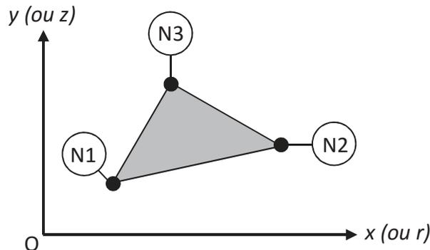
Figure 3 – Maillage éléments finis avec 1 élément
