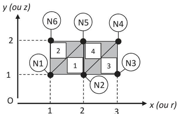
Figure 1 – Maillage éléments finis avec 4 éléments
