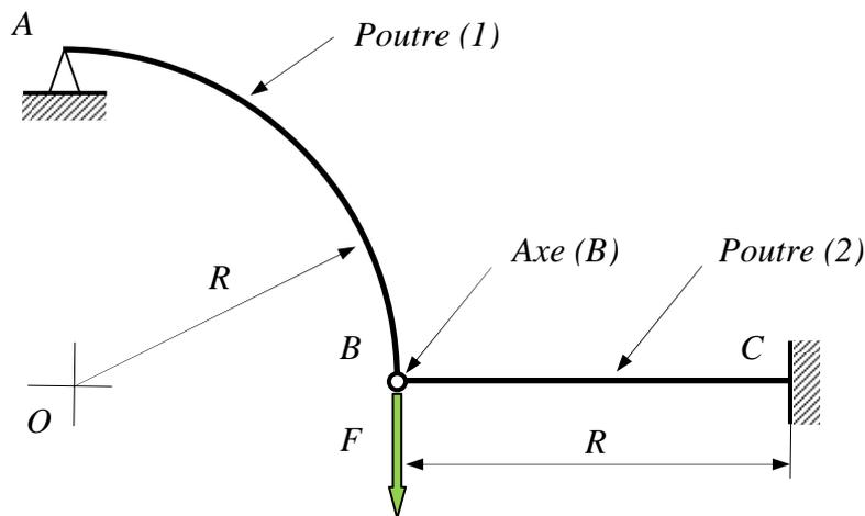
1- Déterminer le degré d'hyperstaticité du système
