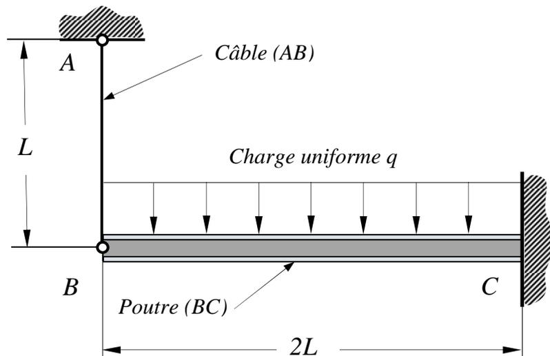
1- Déterminer le degré d'hyperstaticité de la structure
