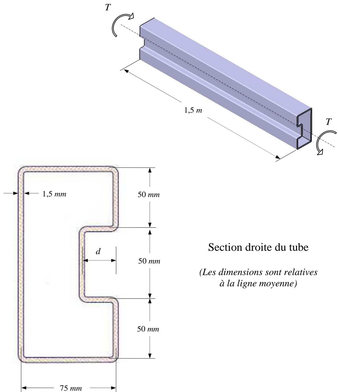
1- Déterminer la valeur maximale de la cote  $d$  (voir section droite du tube ci-dessus) si la contrainte de cisaillement ne doit dépasser la contrainte de cisaillement maximale admissible  $\tau_{max adm}$ .
