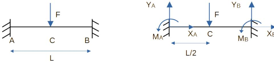
FIGURE 1 – poutre bi encastrée
