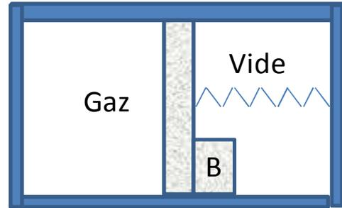
1. Initialement, le piston est coincé par une butée B, le ressort n'est pas tendu, la pression du gaz vaut  $P_0 = 0,241 \text{ bar}$  et sa température  $T_0 = 290 \text{ K}$ . Calculer le volume  $V_0$  occupé initialement par le gaz.
