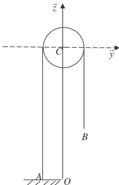
Le paramétrage retenu s'écrit :  $\overline{AC} = r\vec{y} + a(t)\vec{z}$ ,  $\overline{AB} = 2r\vec{y} + c(t)\vec{z}$ . Il n'est pas compatible avec la liaison par fil inextensible. Nous allons rechercher l'équation de liaison. On connaît une configuration de référence :  $a = 5r, c = 0$ .
