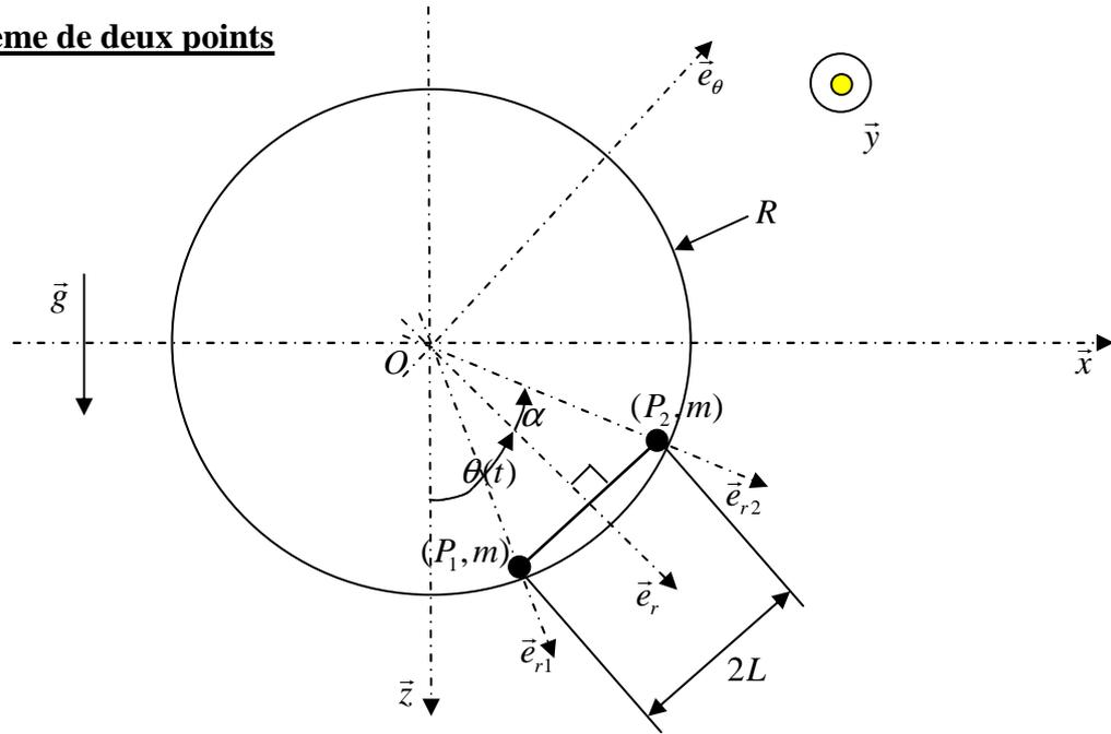
Avec,  $\alpha$ , un angle de réglage constant tel que  $\alpha \in [0, \pi/2]$ ,  $\tan(\alpha) = \frac{L}{\sqrt{R^2 - L^2}}$ .
