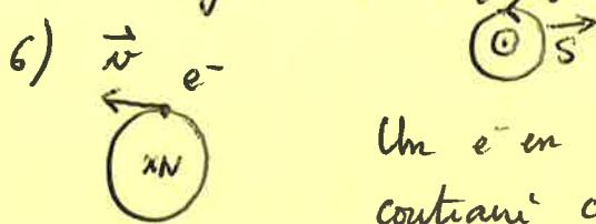
Un  $e^-$  en mouvement est équivalent à un courant en sens contraire car  $e < 0$  d'où  $\vec{M} = \frac{e}{4\pi} \frac{v^2 r}{2} \vec{n}$
