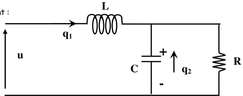
$q_2$  représente la tension de sortie et  $q_1$  le courant dans l'inductance. On désire réguler la tension de sortie vers une consigne constante  $V_d$  (tension désirée) par l'intermédiaire de la commande  $u$  (tension d'alimentation)
