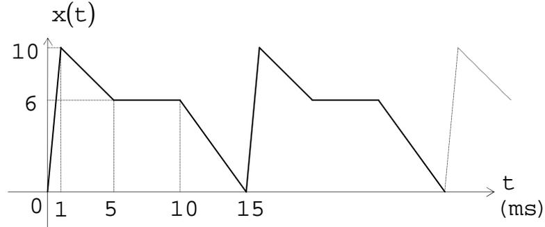
On désire échantillonner ce signal afin de le traiter numériquement. La fréquence d'échantillonnage a été fixée empiriquement de façon à obtenir au moins 10 échantillons dans la partie la plus raide du signal.
