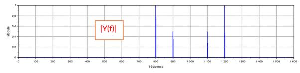
La modulation introduit une transposition en fréquence du spectre de x(t) autour de la fréquence de la porteuse ( $f_0$ =1000Hz). |Y(f)| est le spectre du signal transmis par voie Hertzienne.
