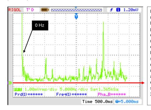
permet de repérer le balourd généré par l'absence de deux pâles. On rappelle également qu'un balourd radial sur une ligne d'arbre rotation à fo fait apparaître des composantes spectrales à f<sub>0</sub>, 2f<sub>0</sub>, etc...
