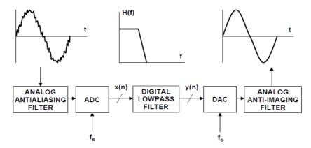
C'est un filtre anti-repliement destiné à borner le spectre du signal à échantillonner. Cela permet de limiter (lorsque sa fréquence de coupure est égale à fe/2 : fréquence de Nyquist) voire d'annuler le repliement de spectre.
