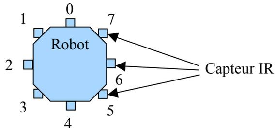
Le robot explore son environnement en poursuivant une direction  $d$  correspondant au numéro d'un de ses 8 capteurs IR. Si un obstacle est détecté par un des capteurs  $d$ ,  $d-1 \pmod{8}$  ou  $d+1 \pmod{8}$ , le robot modifie sa trajectoire de la façon suivante :
